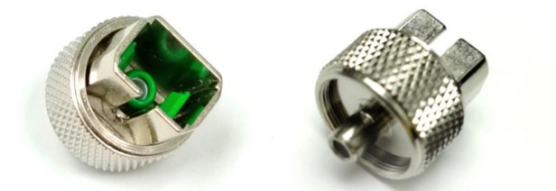
รูปที่ 3 รูปแบบของ connector adapter ที่พบปัญหา misalignment
